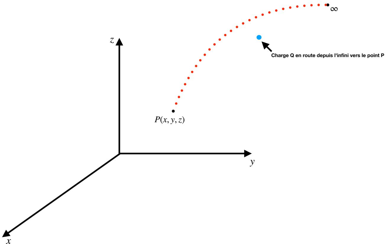
FIGURE 2. DÉFINITION DU POTENTIEL ÉLECTROSTATIQUE PAR RAPPORT À L'INFINI.
